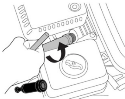
Рис. 22 Обслуживание свечи зажигания
