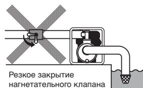
При наполнении водой всасывающий шланг оказывает воздействие на насос, в результате чего насос может упасть в котлован. Не допускайте падения в котлован всасывающего шланга, заполненного водой. Сильный рывок может привести к повреждению шланга и корпуса насоса.
