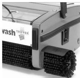
Боковая щетка предназначена для чистки углов возле стен. Перед установкой боковой щетки выключите машину и отключите ее от источника основного питания.
