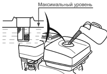
Рис. 5 Максимальный уровень топлива в топливном баке
