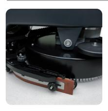
Accesso rapido al serbatoio di recupero e al galleggiante, facilmente ispezionabile. Fermi macchina contenuti grazie alla facilità costruttiva e di manutenzione. Grande visibilità ed efficacia di pulizia con entrambi i lato della spazzola negli angoli difficili da raggiungere.
