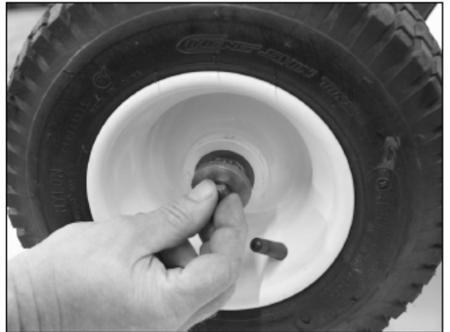
8) Установить болт с гайкой
