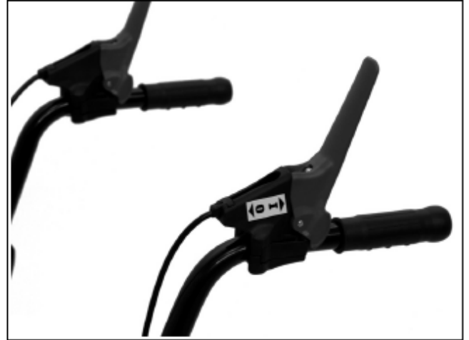
2) Переключающий рычаг находится в исходном положении
