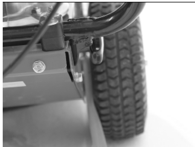
2) Задняя ось служит в качестве точки крепления
