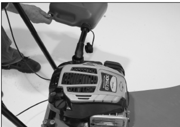
2) Нужно держать канистру, как показано на иллюстрации. Следует заливать небольшими порциями и контролировать наполнение.
