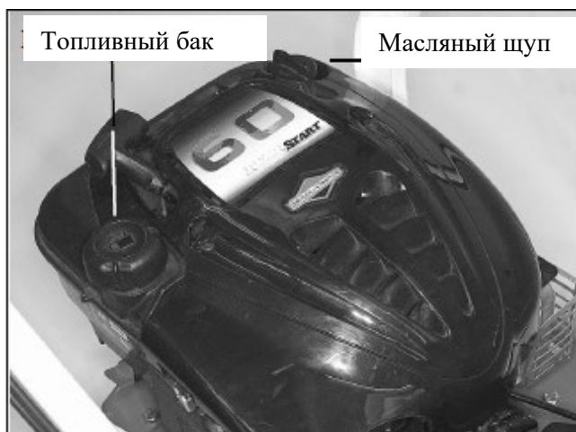
1) топливный бак и масляный резервуар двигателя V&S
