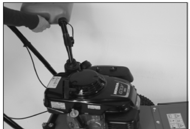
2) Нужно держать канистру, как показано на иллюстрации. Следует заливать небольшими порциями и контролировать наполнение.
