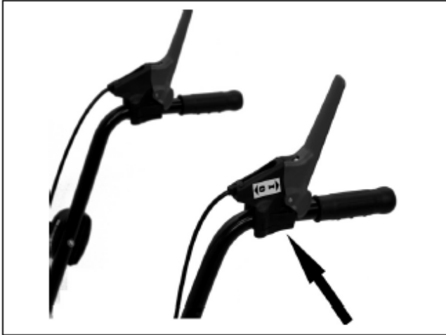
1) На руле находится переключающий рычаг для колесного привода
