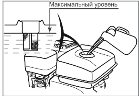
Рис. 5 Максимальный уровень топлива в топливном баке
