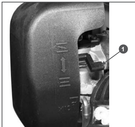
Рис. 6 Расположение рычага управления воздушной заслонкой
