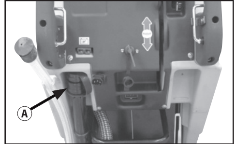
Photo 25 A) Le tuyau de vidange du réservoir de récupération à débit réglable
